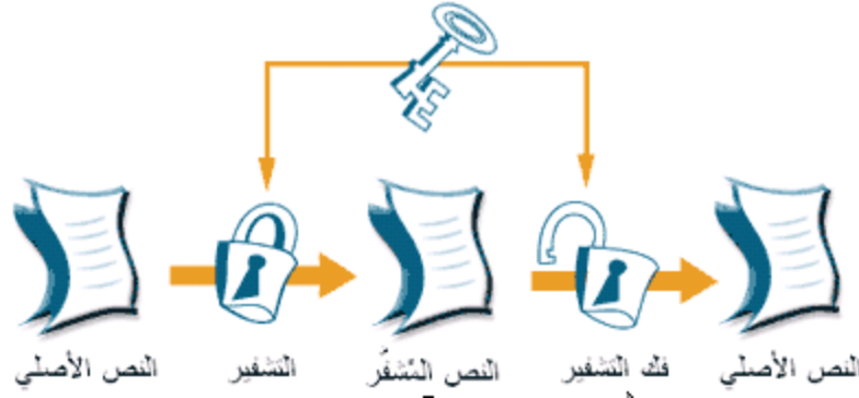
الشكل (1.1) استخدام المفتاح السري في التعمية وفك التعمية في التعمية المتناظرة.
