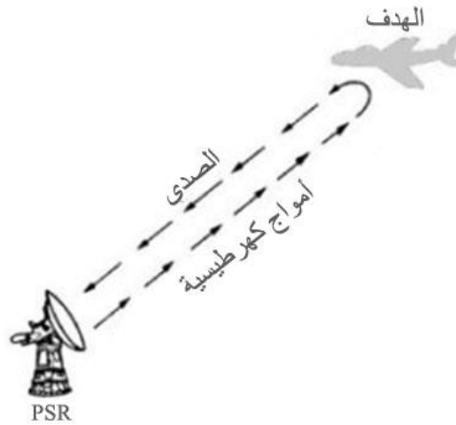
الشكل 2-2: مبدأ عمل نظام PSR.
