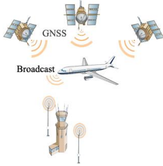
الشكل 2-4: مبدأ نظام بث السطح الآلي المستقل ADS-B.
