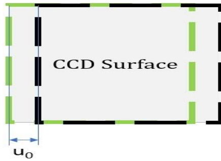
الشكل 23: الانزياح الجانبي u_0 وذلك بأخذ صورتين مزاحتين إحداهما بالنسبة إلى الأخرى
