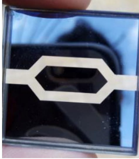
الشكل ٣٩: شريحة زجاج مطلية بمادة الكروم لتشكل وصلة Y-junction
