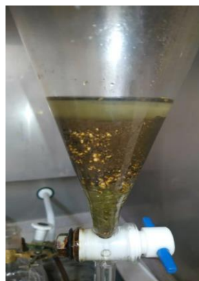
الشكل 20: نقع البيرين بالمذيب وفق طريقة الاستخلاص المتكرّر
