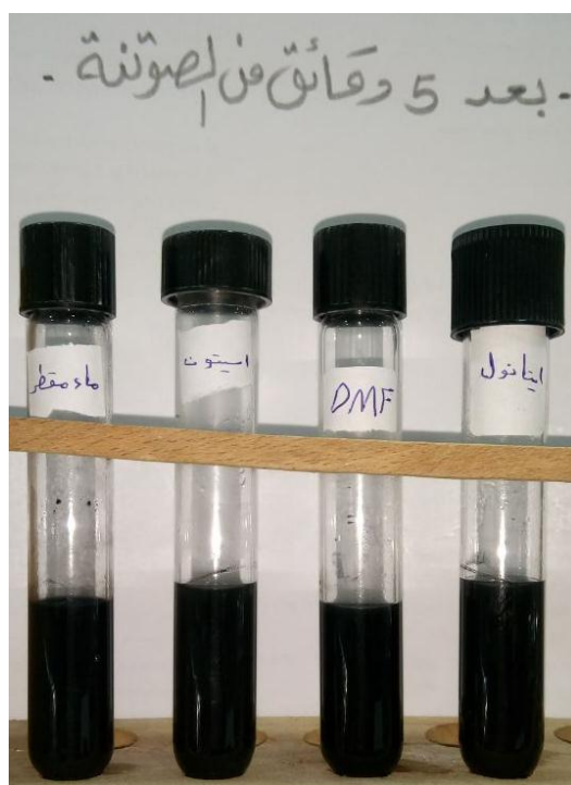
الشكل (3-16): GO في المذيبات المختلفة (الماء المقطر-الاسيتون-ثنائي متيل اميد -الايثانول) بعد الصوتنة بخمس دقائق
