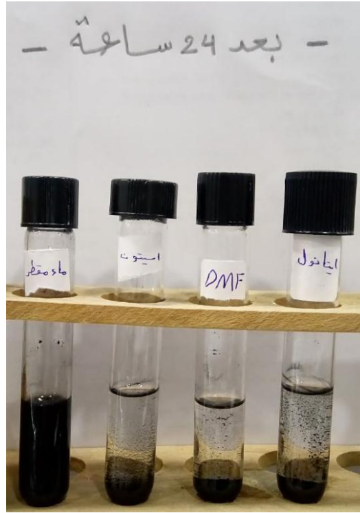
الشكل (3-17): GO في المذيبات المختلفة (الماء المقطر-الاسيتون-ثنائي متيل اميد -الايثانول) بعد الاذابة بـ 24 ساعة
