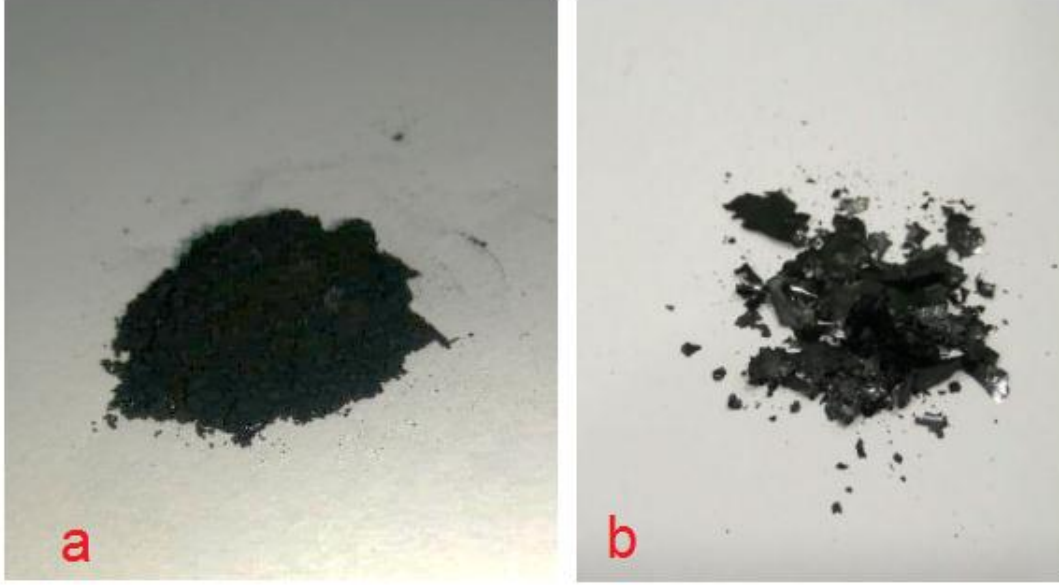
الشكل (3-14): عينات أكسيد الجرافين المرجع المحضرة (a) أكسيد الجرافين محضر كهركيميائياً. (b) أكسيد الجرافين محضر كيميائياً.
