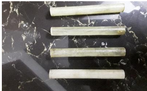
الشكل (٢-١٦): مراحل تحضير القالب الشمعي للعينات الاسطوانية.
