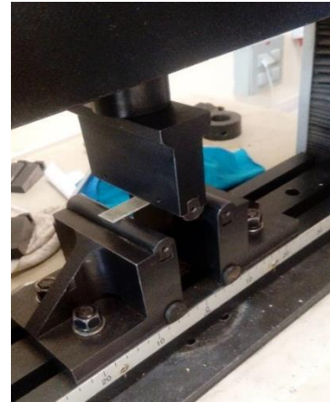
الشكل (٢-٢٧): اختبار الانعطاف لعينات المواد المركبة.
