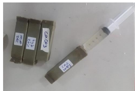
الشكل (٢-١٦): مراحل تحضير القالب الشمعي للعينات الاسطوانية.
